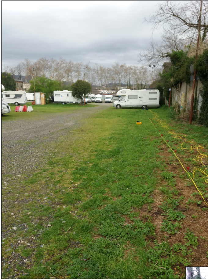
STESA SISMICA M1 – AREA “A” (tipo MASW) – 24 canali Interasse geofoni: 1,5m
