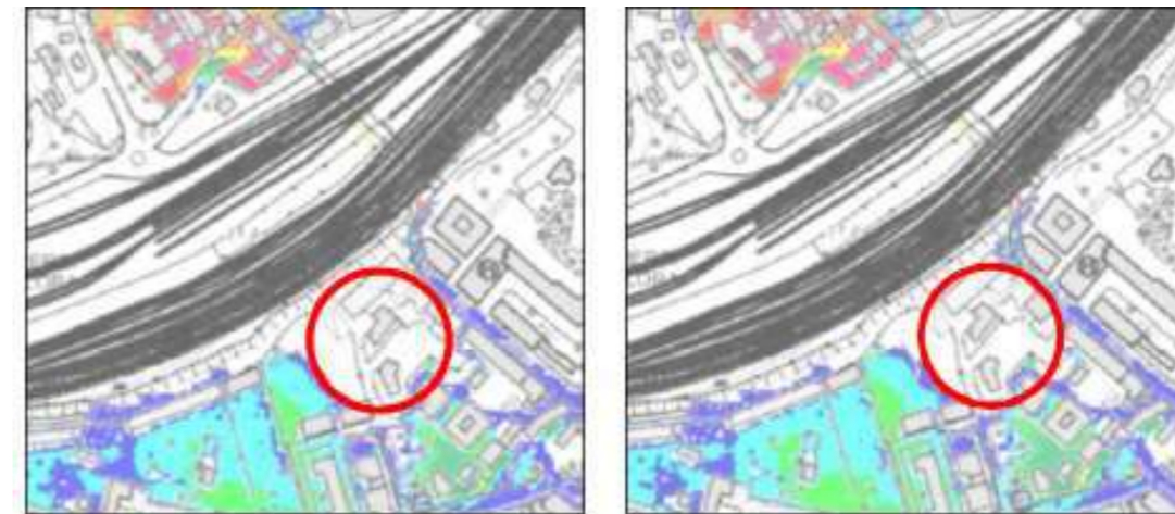
Estratto cartografico del settore in esame con evidenziate le perimetrazioni delle aree bagnate per Tr 50 anni e 200 anni, proposte a seguito della realizzazione degli interventi di mitigazione del rischio idraulico (Hydrodata, 2021).
