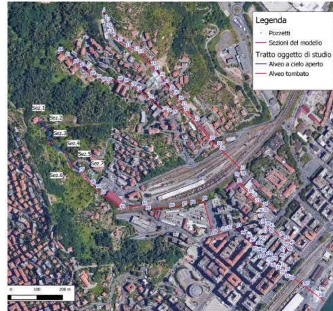
Figura 20 – Network complessivo del modello monodimensionale (MIKE11 + MIKE Urban) allestito per il rio Val dell'Orla nell'assetto attuale.
