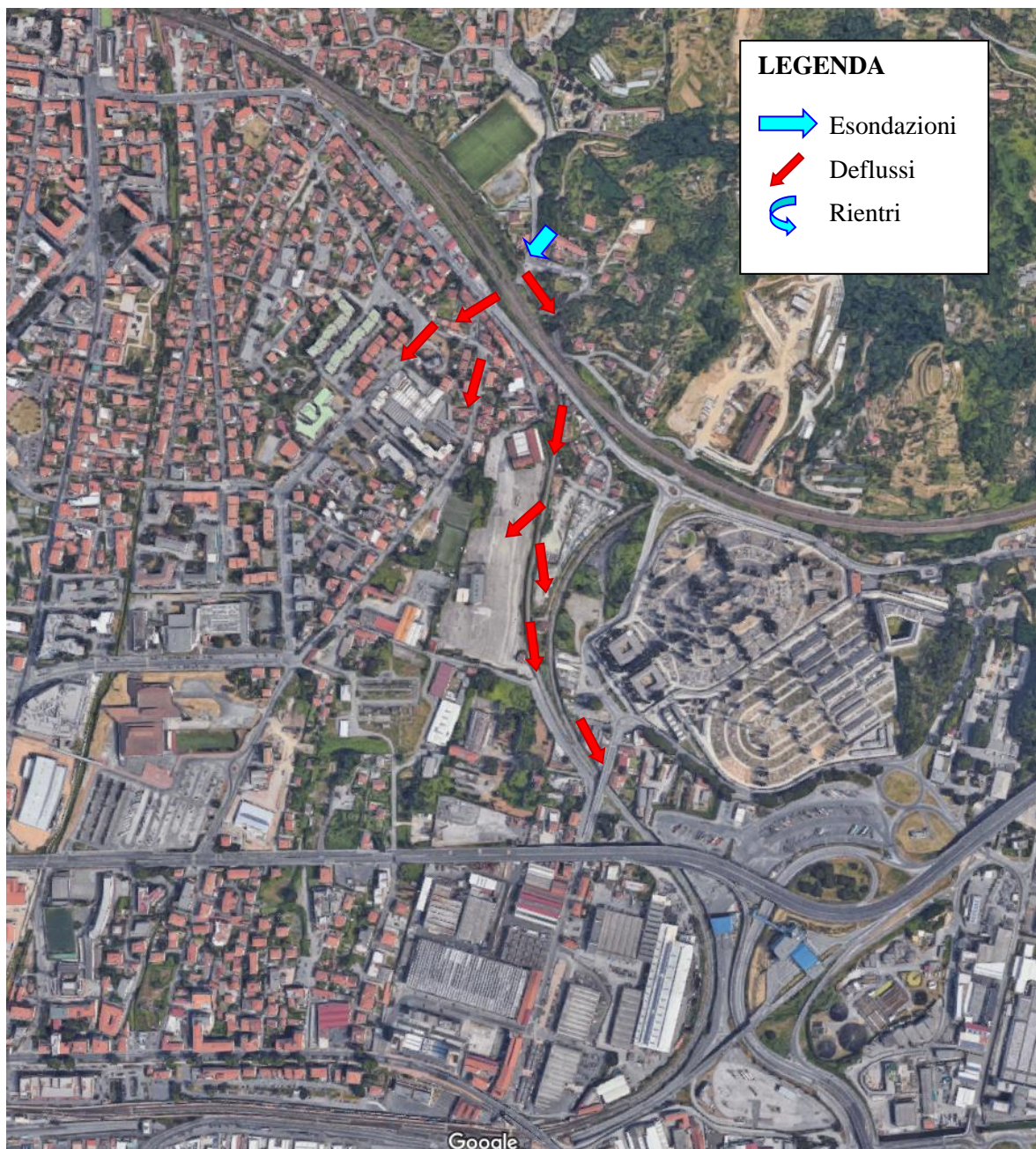
Figura 4: foto aerea con indicati i punti di esondazione e le via di deflusso principali
