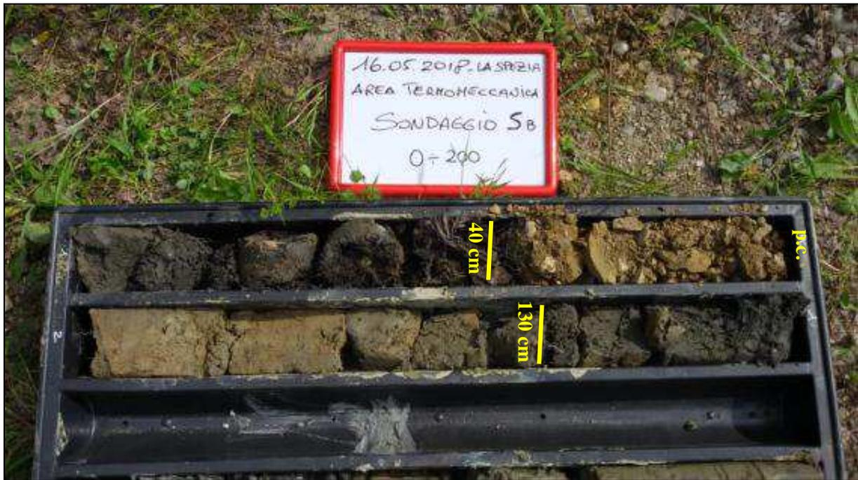
Figura 14 - Carote sondaggio Sb
