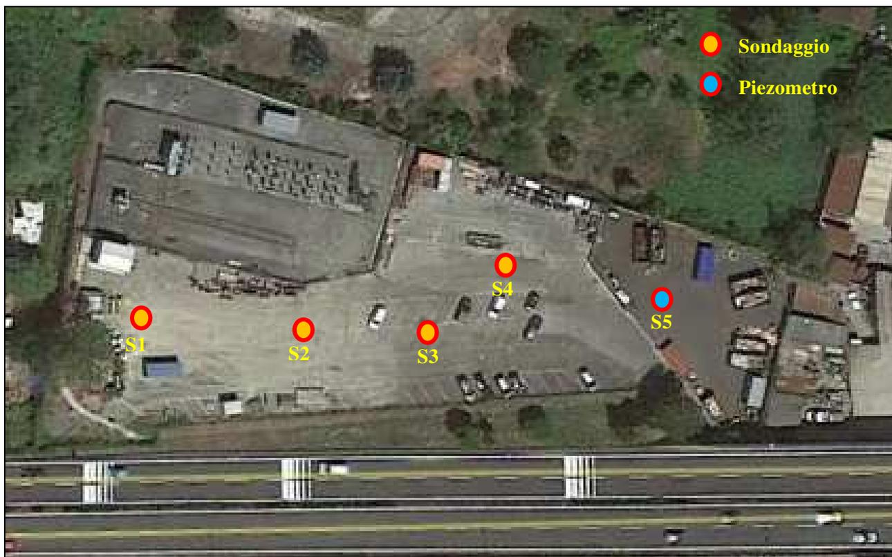
Figura 6 – Planimetria punti di indagine in area Termomeccanica
