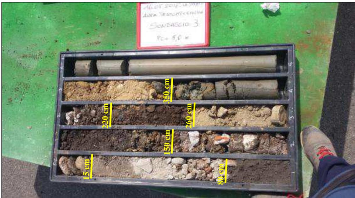
Figura 9 - Carote sondaggio S3 (area Termomeccanica)
