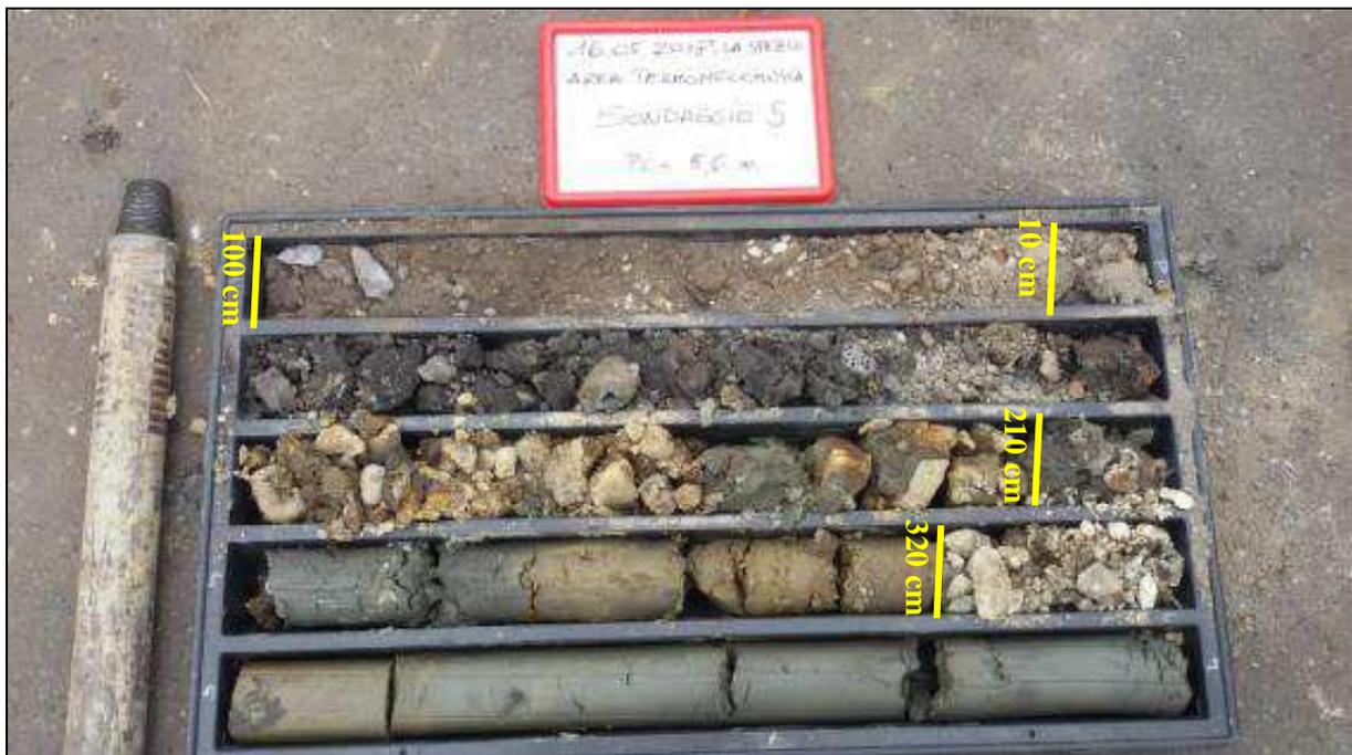
Figura 11 - Carote sondaggio S5 (area Termomeccanica)
