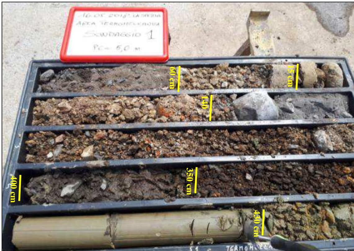
Figura 7 – Carote sondaggio S1 (area Termomeccanica)
