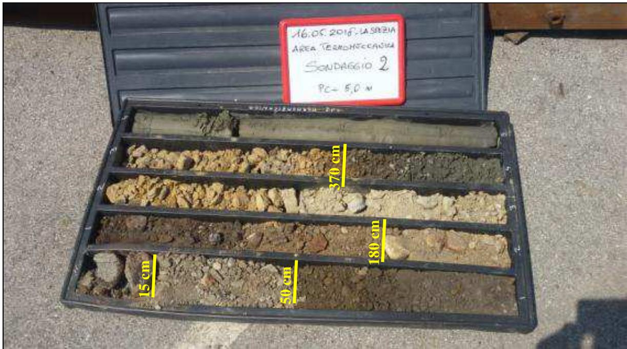
Figura 8 - Carote sondaggio S2 (area Termomeccanica)
