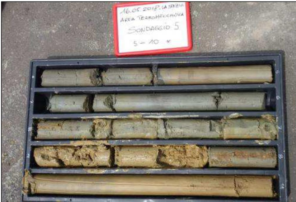
Figura 17 – Stratigrafia suolo saturo sondaggio 5
