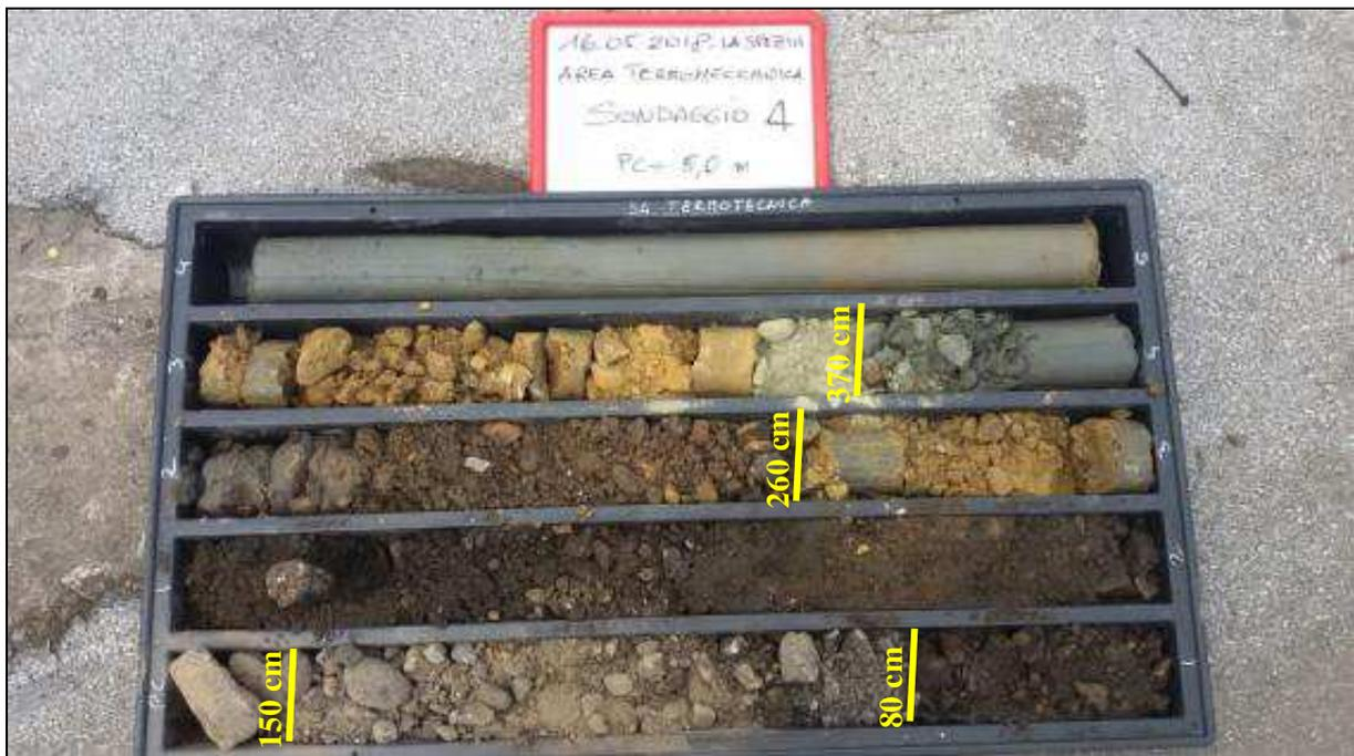
Figura 10 - Carote sondaggio S4 (area Termomeccanica)
