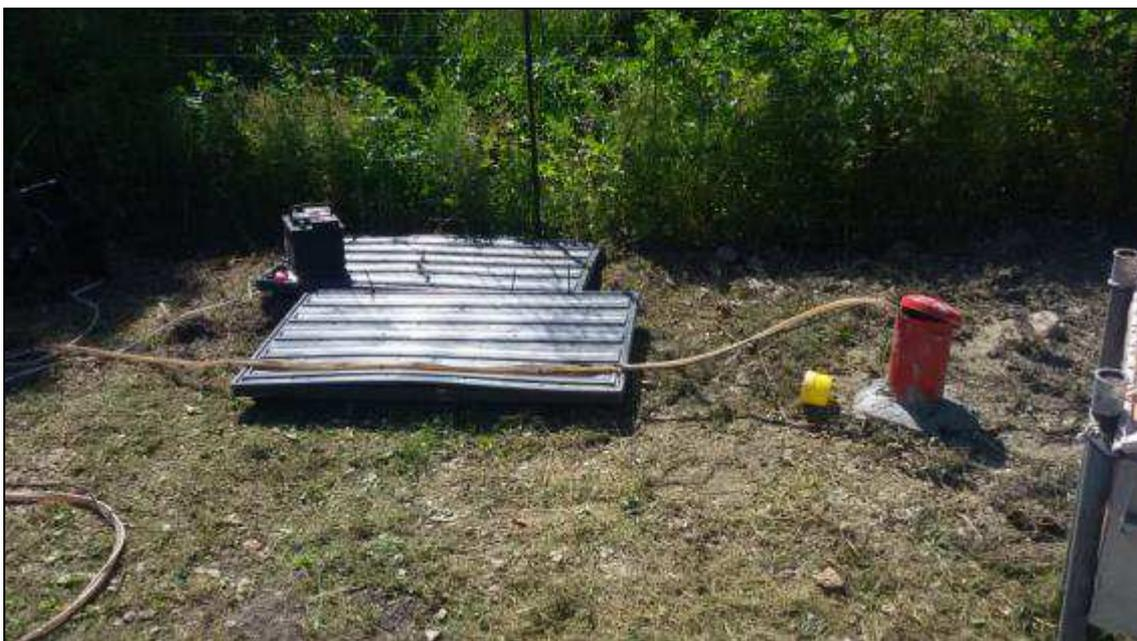
Figura 21 - Campionamento piezometro PZSc
