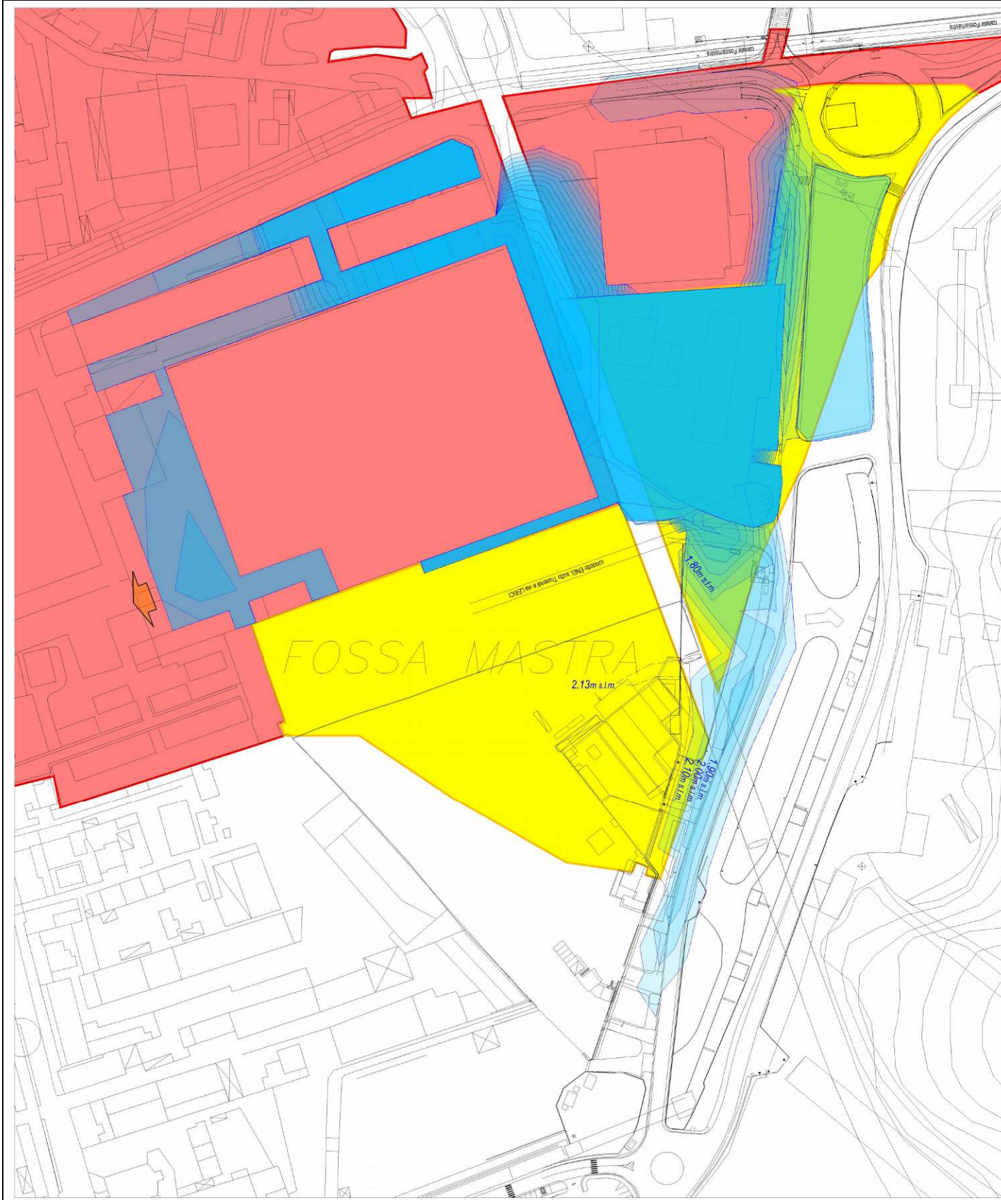
GRAFICO 5: HYDRO_02 (Tp=2*Tc) - confronto massima espansione aree allagabili con le fasce ADB
