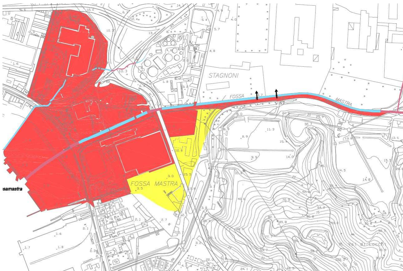
Figura 8: Regione Liguria – Autorità di bacino regionale - Piano Stralcio per la tutela dal rischio idrogeologico – Ambito 20 – Golfo della Spezia – Stralcio della Tavola 9 “Carta delle aree inondabili”, con evidenza della fascia di inondabilità A (in colore rosso) e della fascia di inondabilità B (colore giallo) per il Canale Fossamastra
