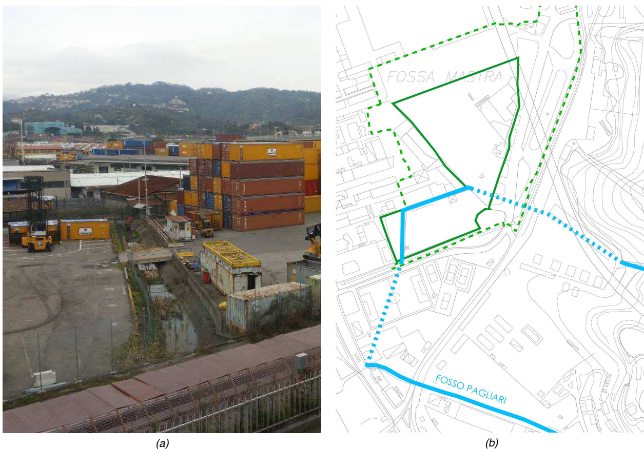
Figura 11: (a) Ripresa fotografica della tratta a cielo aperto del Fosso Pagliari B presente all'interno delle aree Tarros e (b) sovrapposizione del reticolo idrografico relativo al Fosso Pagliari e suo tributario con la CTR Regionale in scala 1:5.000 (anno 2000)
