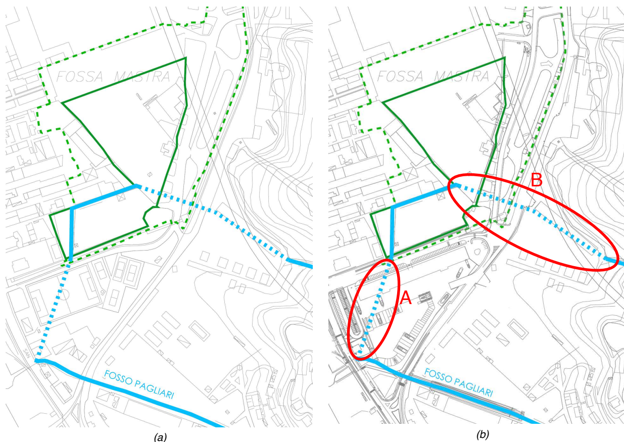
Figura 13: Sovrapposizione del reticolo idrografico relativo al Fosso Pagliari e suo tributario con: (a) la CTR Regionale in scala 1:5.000 anno 2000; (b) la CTR Regionale anno 2007 integrata con il rilievo della nuova darsena ed opere connesse.
