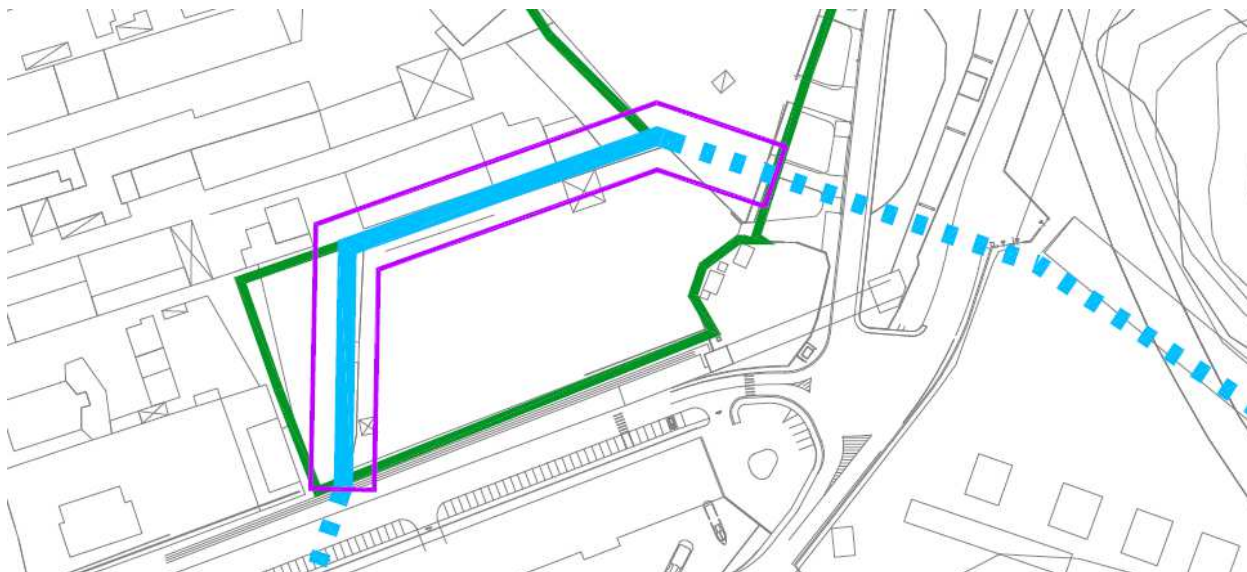
Figura 12: Planimetria con indicazione della fascia di rispetto da considerare in relazione al tratto del Fosso Pagliari B che transita all'interno delle sub-distretto API5/a (cd "aree Tarros")
