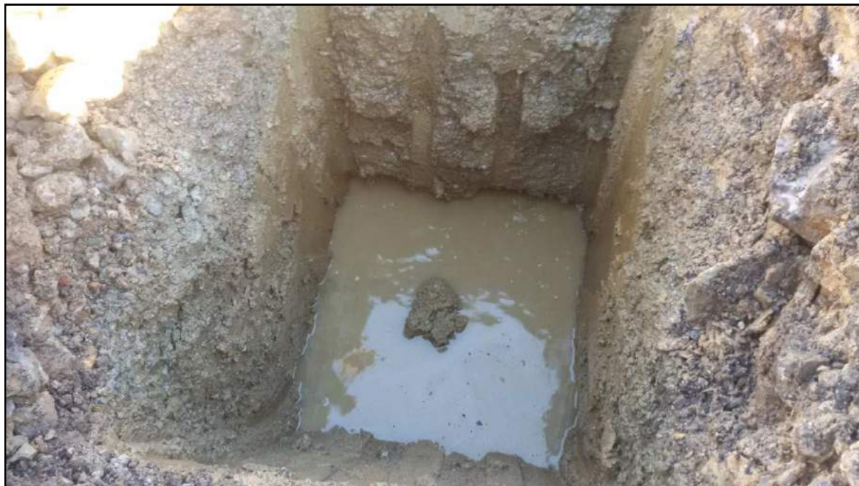
Figura 2 - acque di impregnazione nel pozzetto esplorativo
