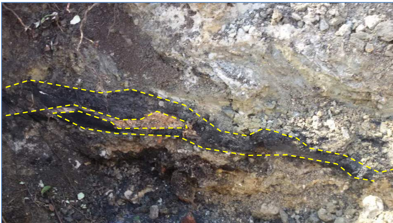
Figura 6 - Microstratificazioni di rifiuti a matrice carboniosa con elevato tenore di zinco
