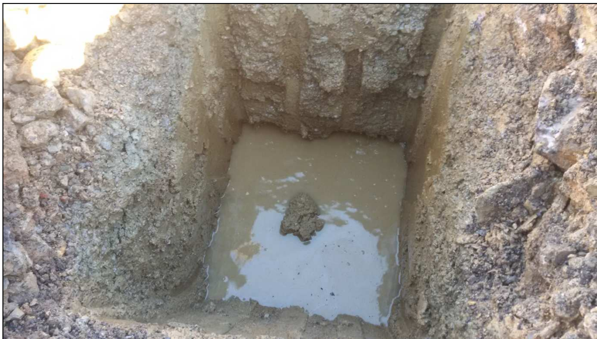
Figura 3 - acque di impregnazione nel pozzetto esplorativo
