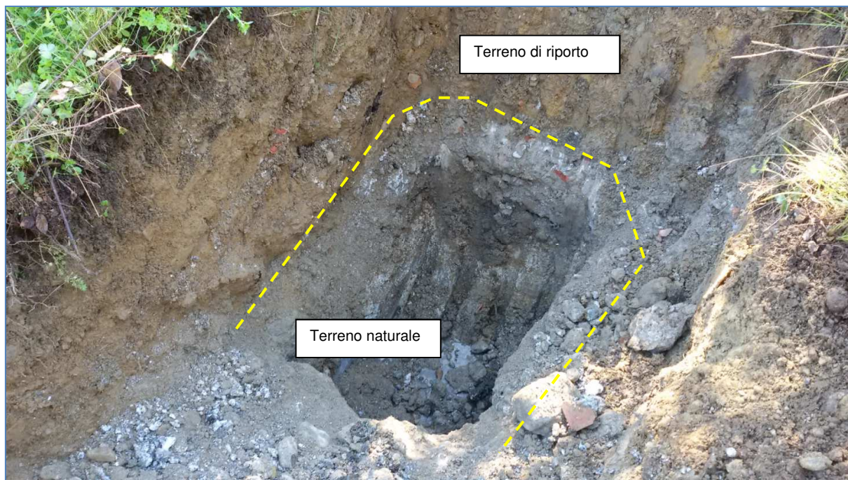
Figura 6 - terreno di riporto soprastante gli scarti di processo e/o i terreni naturali
